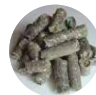
燃えるごみから生成さ れた固形燃料（RDF）
