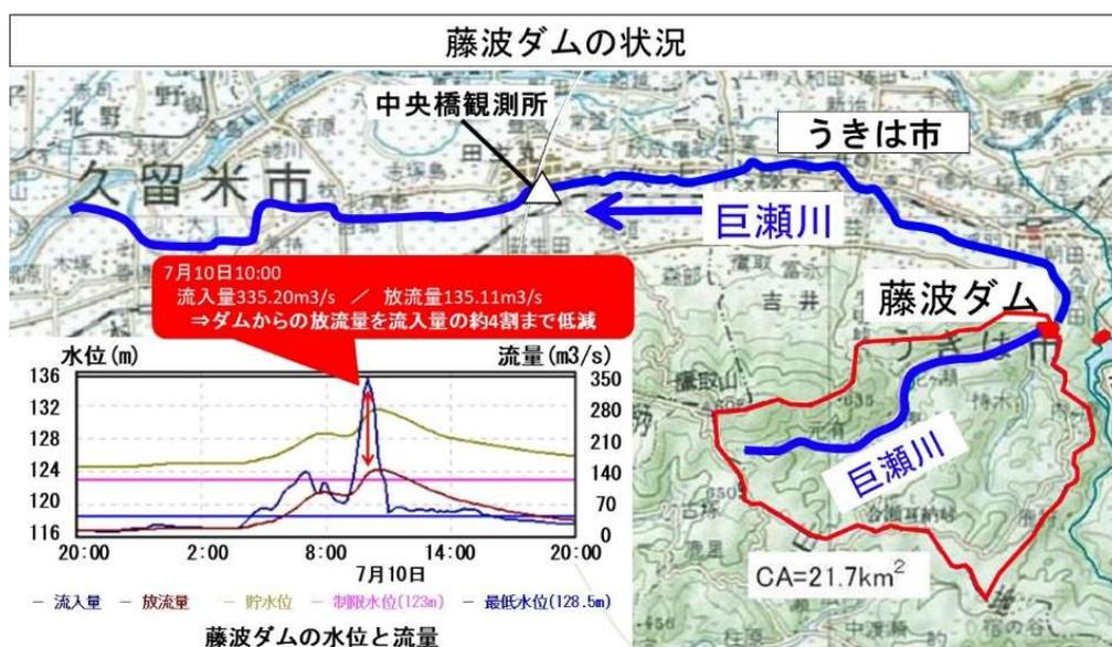
⇒ 藤波ダムが緊急放流（非常用洪水吐からの越流）に移行することが想定されました。洪水調節に用いる容量を増やす必要があります。
