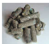
◀耳納クリーンステーション で製造される固形燃料
