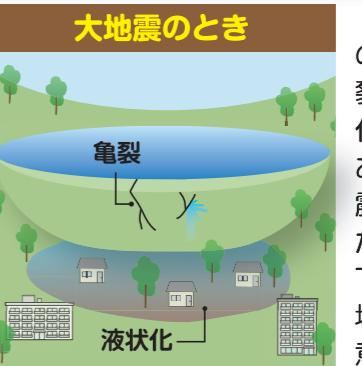
大地震のときに、ため池の堤防が異常な力を受け亀裂が生じたり、地盤の液状化により決壊する危険性があります。比較的小さな地震でも、堤防の内部に生じた亀裂などにより強度が低下し、水圧に耐えきれず決壊に至ることがあるので注意が必要です。
