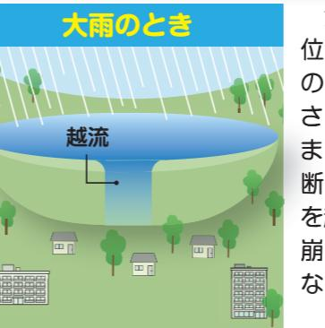
大雨のとき、ため池の水位が上昇し堤防を越えた水の勢いによって堤防が浸食され、決壊することがあります。竹や流木が洪水吐の断面を閉塞させると、堤防を越流しやすくなり、浸食・崩壊の危険性は、一層高くなります。
